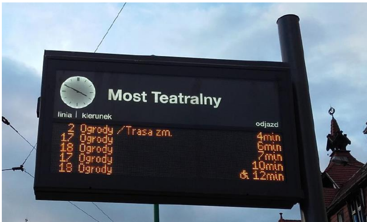
Fot. 20 Tablica 5-wierszowa (4+1) – oświetlenie w porze nocnej.
